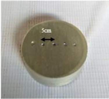
Gambar 4.3 Spesimen uji kekerasan
