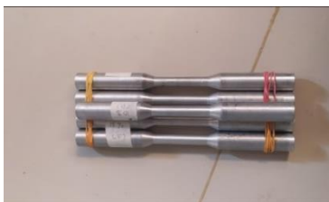
Gambar 4.1. Gambar Spesimen Pengujian Tarik
